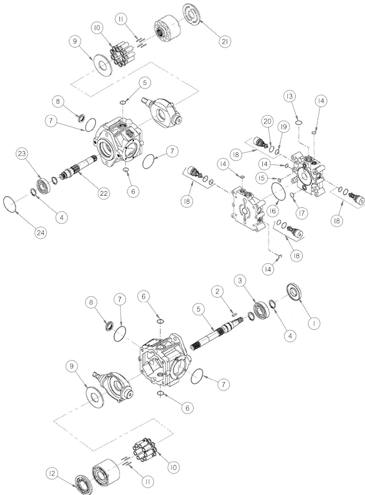
**РЕМОНТНЫЕ ЧАСТИ НАСОСА ПРИВОДА ХОДА**
